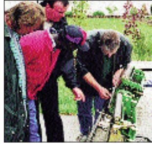
Eine Möglichkeit, die Grüns schneller zu machen: die Bügelmaschine mit vibrierenden Walzen. Der Unterschied in der Grünsgeschwindigkeit wurde nach dem Bügeln mit dem Stimpfmeter gemessen.
