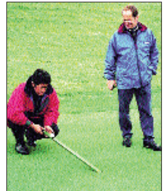
Die Messung mit dem Stimpfmeter ergab nach dem Bügeln eine deutliche Erhöhung der Grünsgeschwindigkeit.
