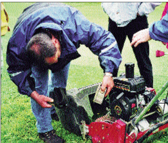
Bei Inbetriebnahme jeder Maschine gehört die WOLKE zur routinemäßigen Kontrolle. Hier: Das Reinigen des Luftfilters.
